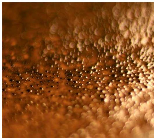
Битумная эмульсия (эмульгированный жидкий битум) - искусственный строительный материал, получаемый путем смешения в специальных установках водного раствора эмульгатора и нефтяного битума. Представляет собой однородную текучую (с консистенцией молока) жидкость коричневого или темно-коричневого цвета.
